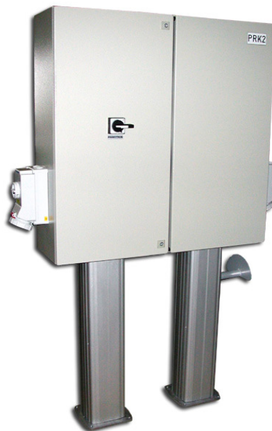
VR 24 pistorasiakeskus 250A/400V kytkinpistorasioilla (mek. lukitus) - tehonkatkaisijat 100A ja 63A
